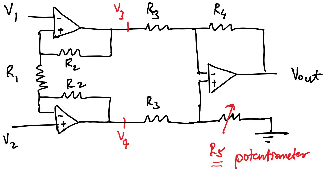
$$V_{out} = \frac{R_5}{R_3} \frac{(R_3 + R_4)}{(R_3 + R_5)} V_4 - \frac{R_4}{R_3} V_3$$
